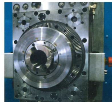
Andock-Vorrichtung für das automatische Befestigen von Fräspanparaten etc.
